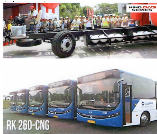
Sumber: PT Hino Motors Manufacturing Indonesia, 2018 Gambar 2. Chasis dan Bus Tipe RK 260 Berbahan Bakar CNG
