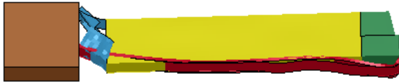
Gambar 3. Deformasi struktur lokomotif pada kecepatan 13,33 m/s sesuai standar APTA 49 CFR Part 238.
