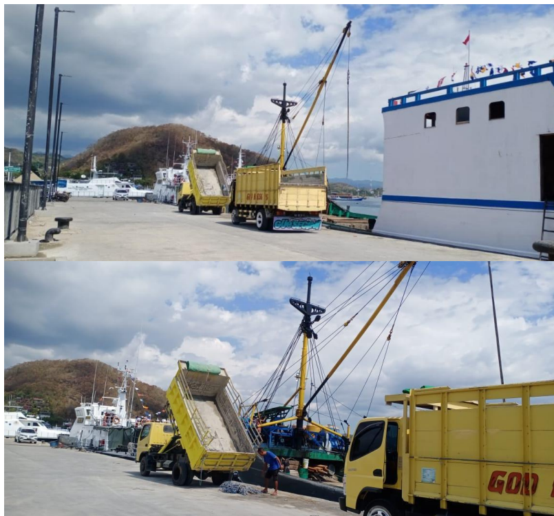
Gambar 4. Proses pembongkaran menggunakan derek katrol dari kapal ke truk.
