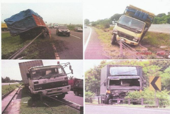
Gambar 8. Hasil Uji Tabrakan Wire Rope Setelah Kecelakaan.
