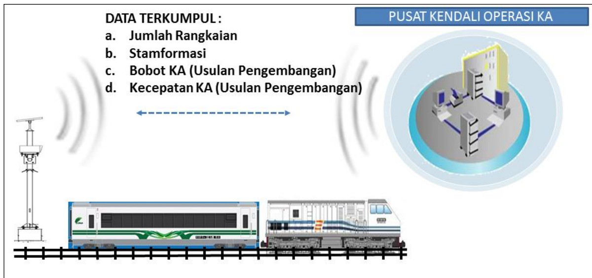
Gambar 1. Prinsip Kerja Alat Ukur Penggunaan Prasarana KA.
