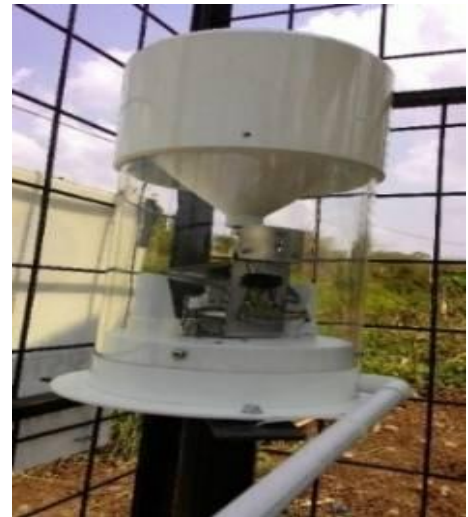
Gambar 5. Bagian-bagian Sensor Curah Hujan dan Foto Sensor Curah Hujan.
