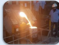
Proses pengecoran pembuatan paduan Fe-Ni
